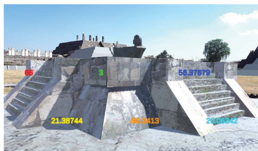
Figura 11. Prueba de integración en el sitio. Fue posible validar la operación de los sistemas de ubicación, orientación y conteo de pasos.
